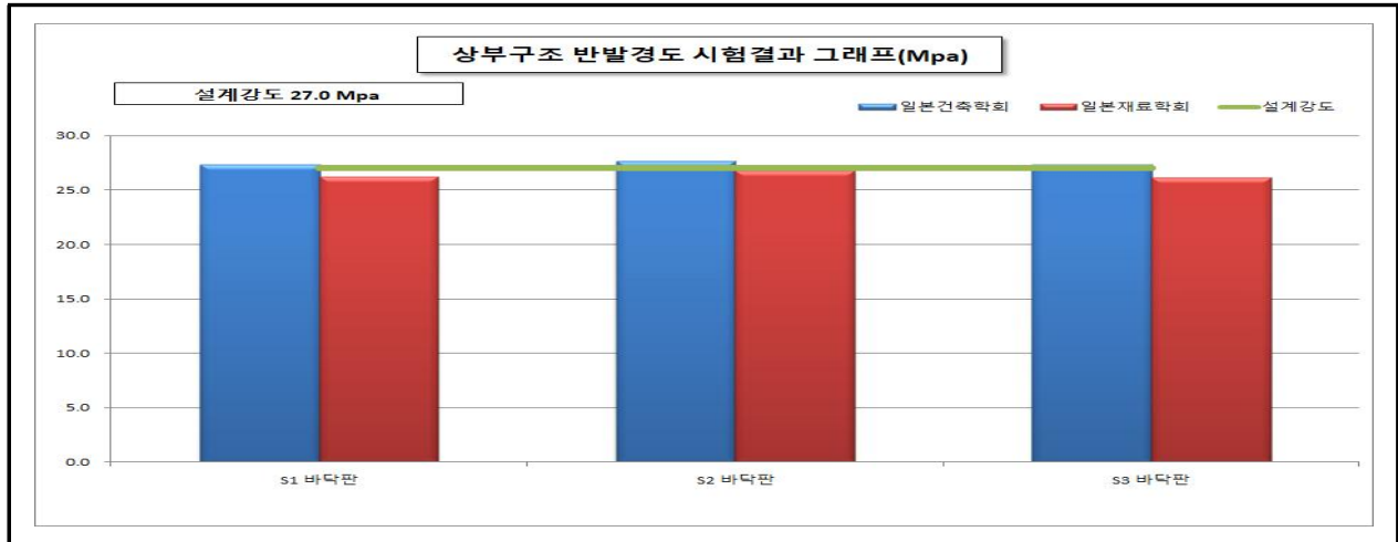
【그림 27.4.3】 상주방향 상부구조 반발경도시험 측정결과
